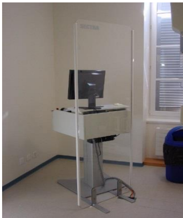
Abbildung 16: Beispiel für eine Schutzwand aus Bleiglas. Quelle: Sectra
