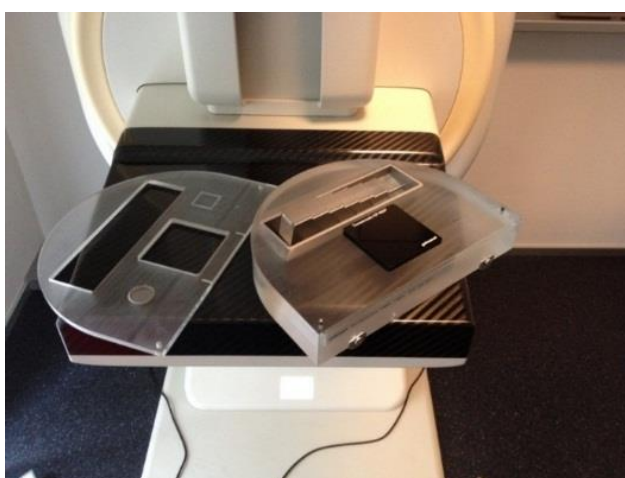
Abbildung 24: Phantom des Typs MTM 100 oder CIRS
